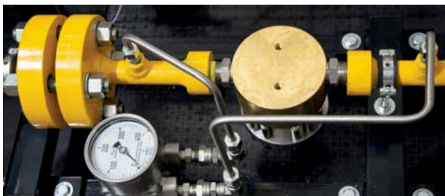
Indicatore di intasamento filtro Clogging filter indicator
